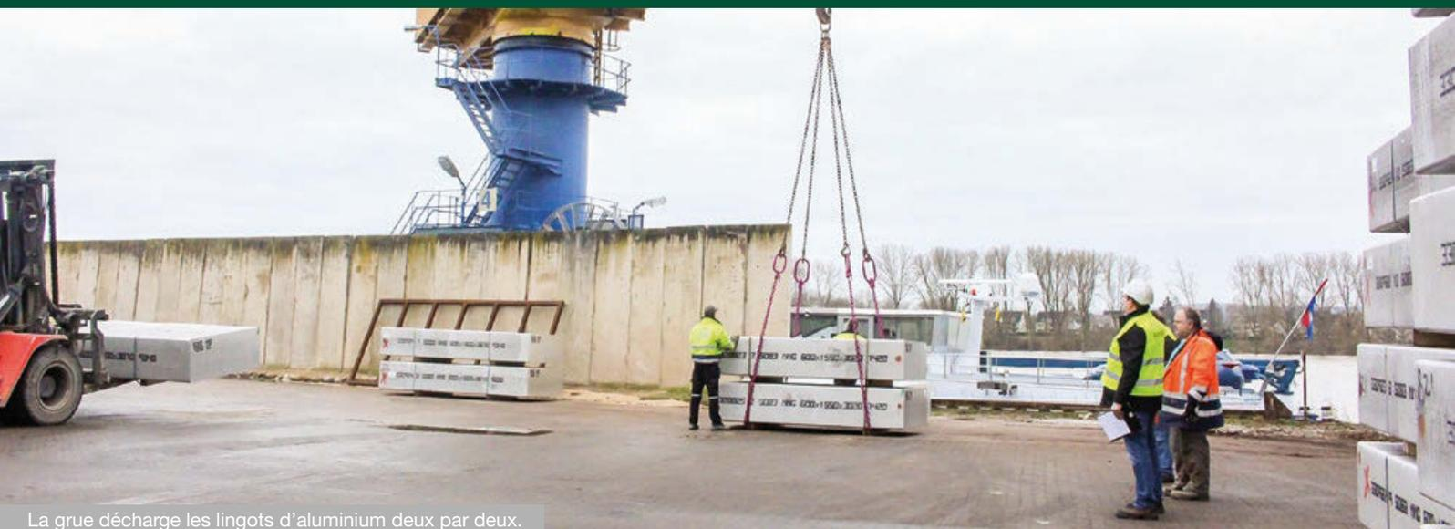
La grue décharge les lingots d'aluminium deux par deux.
