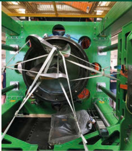
Professionelle Sicherung der Maschine beim Landtransport per Lkw.
