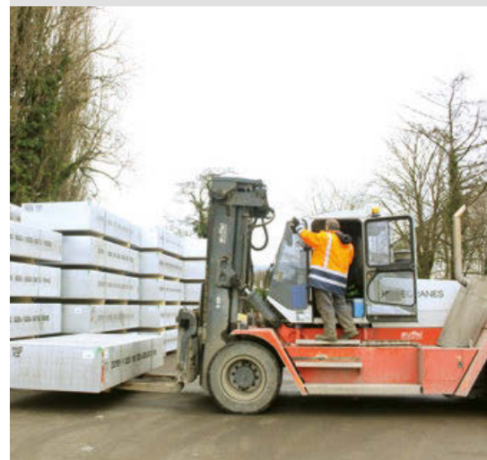
Per Stapler gelangen die Barren an die Stelle an der sie zwischengelagert werden.
