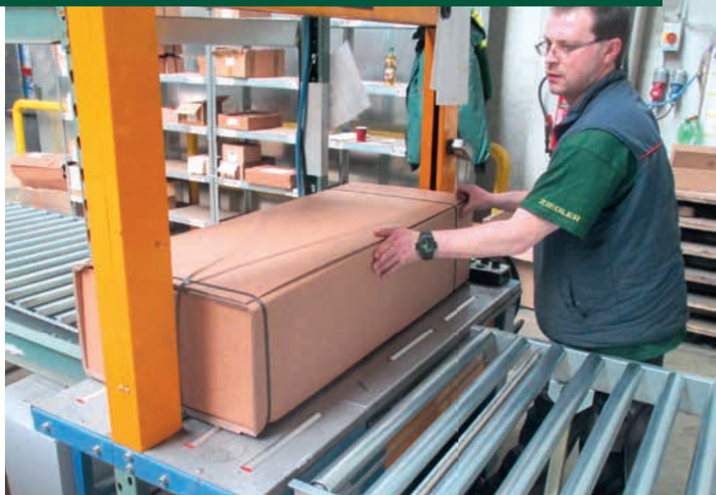
Umreifung in der Bündelmaschine, hier ZIEGLER-Mitarbeiter Sascha Lederer.
